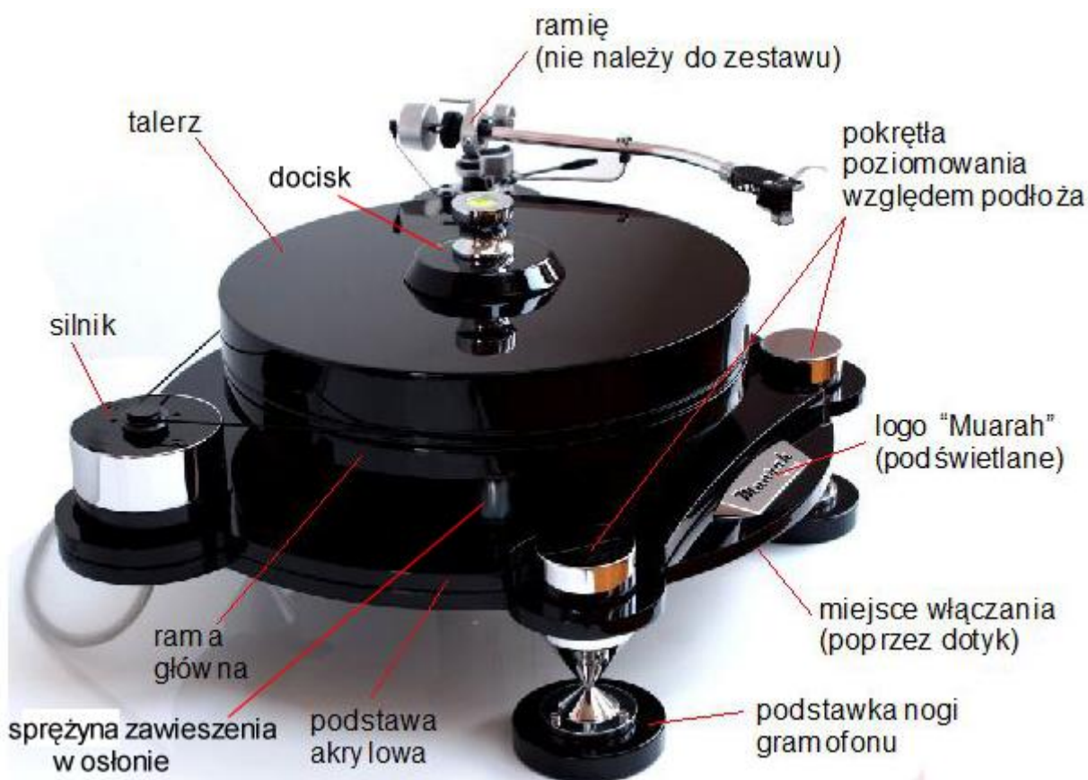
Rysunek 1: Opis i nazewnictwo elementów gramofonu.
