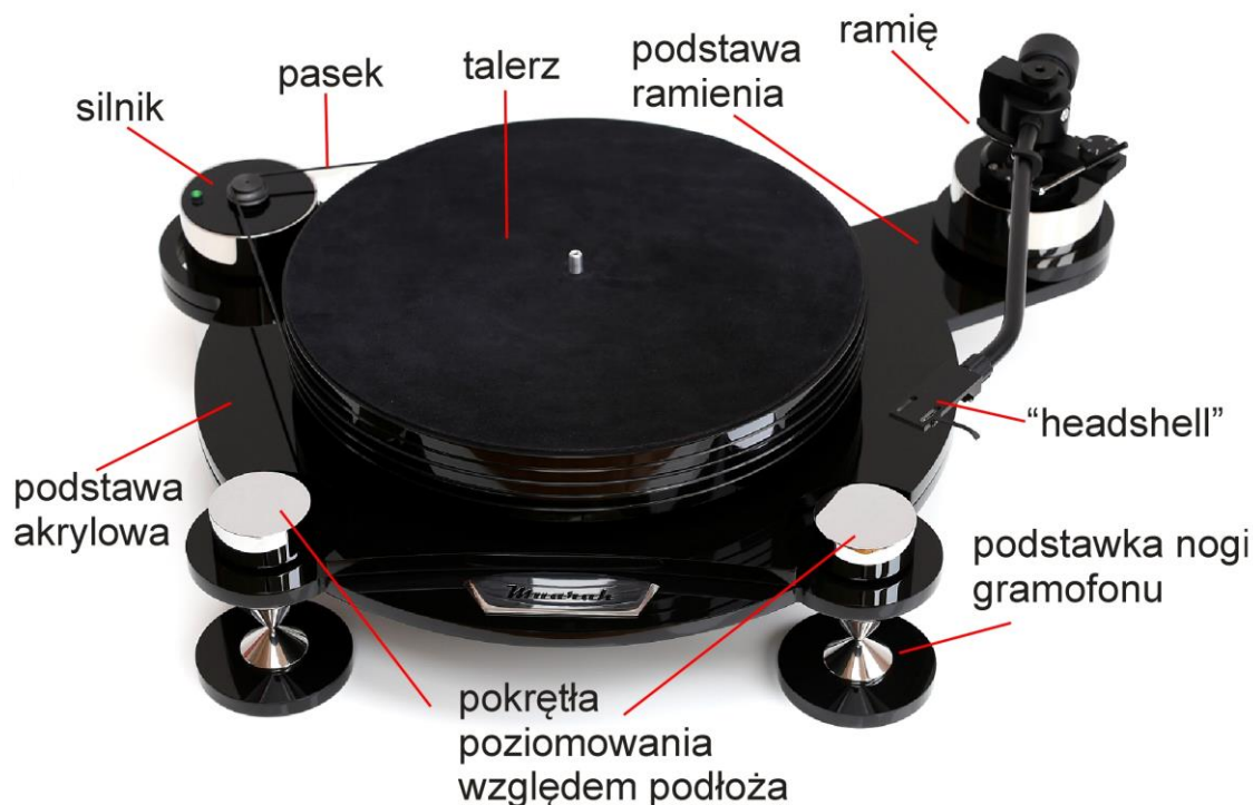
Rysunek 1: Opis i nazewnictwo elementów gramofonu.
